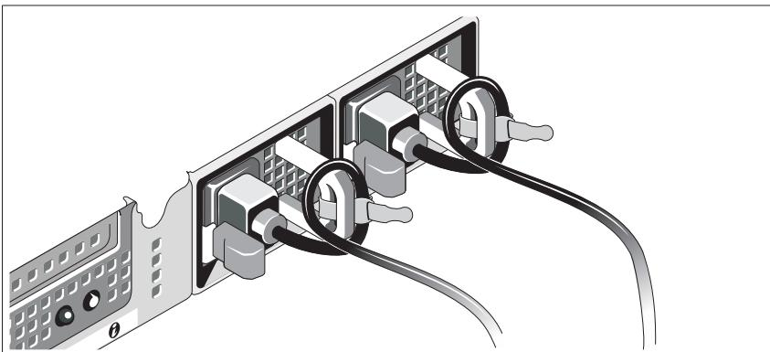
Repliez le câble et faites-le passer dans le clip comme le montre la figure, puis fixez-le à l'aide de la sangle fournie. Branchez ensuite l'autre extrémité du ou des câbles sur une prise de courant mise à la terre ou sur une source d'alimentation autonome (onduleur ou unité de distribution de l'alimentation [PDU]).
