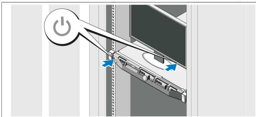
Pulse el botón de encendido del sistema y del monitor. Los indicadores de alimentación deberían encenderse.
