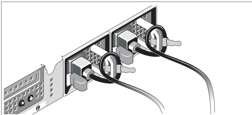
Doble los cables de alimentación del sistema en forma de bucle, como se muestra en la ilustración, y fíjelos al soporte con la correa proporcionada. Conecte el otro extremo de los cables de alimentación a una toma de alimentación eléctrica con conexión a tierra o a otra fuente de energía, como un sistema de alimentación ininterrumpida (SAI) o una unidad de distribución de alimentación (PDU).
