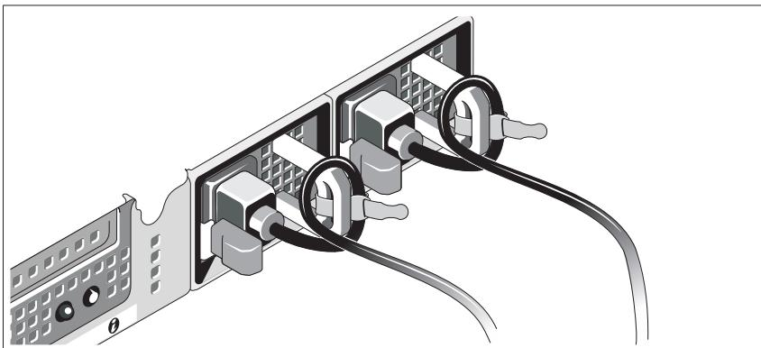
Изогните шнур питания системы в форме петли, как показано на рисунке, и прикрепите его к скобе прилагаемой манжетой. Подключите другой конец кабеля питания к заземленной розетке или отдельному источнику питания, например, к источнику бесперебойного питания или блоку распределения питания.
