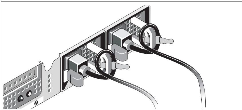
Τυλίξτε τα καλώδια τροφοδοσίας του συστήματος όπως φαίνεται στην εικόνα και στερεώστε τα στο στήριγμα χρησιμοποιώντας την παρεχόμενη ταινία. Τοποθετήστε την άλλη άκρη του καλωδίου (ή των καλωδίων) τροφοδοσίας σε γειωμένη πρίζα ή σε ξεχωριστή πηγή ηλεκτρικού ρεύματος, π.χ. σε ένα σύστημα αδιάλειπτης τροφοδοσίας (UPS) ή μια μονάδα διανομής ρεύματος (PDU).
